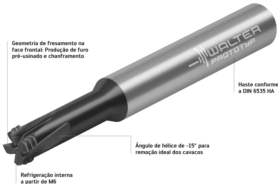
Fresa de metal duro para furação e rosqueamento orbital
